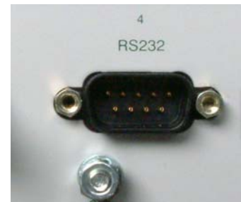
Fig 3. P4-RS232 port & earth stud
